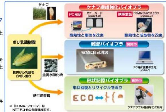
NECでは、IT機器の消費電力低減だけでなく、筐体などに使われる材料の環境負荷低減に取り組んでいます。特に、NECが独自に開発したケナフ繊維強化バイオプラスチックは、2006年3月に発売された「エコケータイ」N701iECOの筐体の大部分に使われています。自然の循環の中で再生される植物を主原料としたバイオプラスチックの使用は、石油系プラスチックと比較して、素材製造時のCO2排出量の削減につながります。今後、他の製品へも使用を拡大していく予定です。
