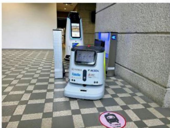
写真：2台のロボットが順番にフラPPERゲートを通過（同方向）
